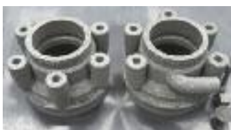
Particolari in Titanio realizzati con produzione additiva Renishaw
