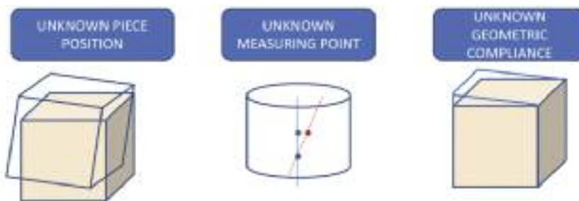
Figura 1: l'errore della misura è in effetti la somma dell'errore di posizionamento del pezzo, dell'errore relativo alla posizione in cui si effettua la misura e dell'errore legato alle tolleranze di lavorazione del pezzo stesso
