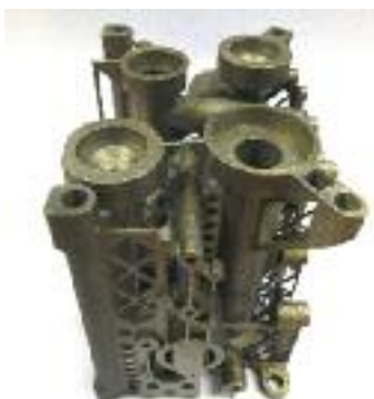
Particolari in Titanio realizzati con produzione additiva Renishaw
