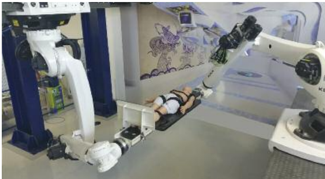
Il posizionamento del lettino sul quale il paziente è sdraiato è eseguito da una coppia di robot antropomorfi Kuka, controllati con elevata precisione da un laser tracker Leica Geosystems
