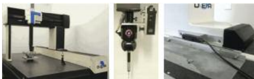
Figura 2: la macchina di misura modificata con l'introduzione di uno scanner laser
